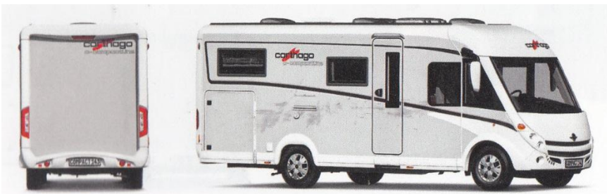
2.12 Mass von den Seitenwänden, und nicht die Gesamtbreite von 2.70 Meter
